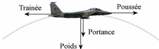
Un avion peut très bien avoir une portance vers le bas. Il suffit d'avoir un angle d'attaque qui permet de pousser l'air vers le haut (un angle d'attaque négatif avec une aile symétrique par exemple).
