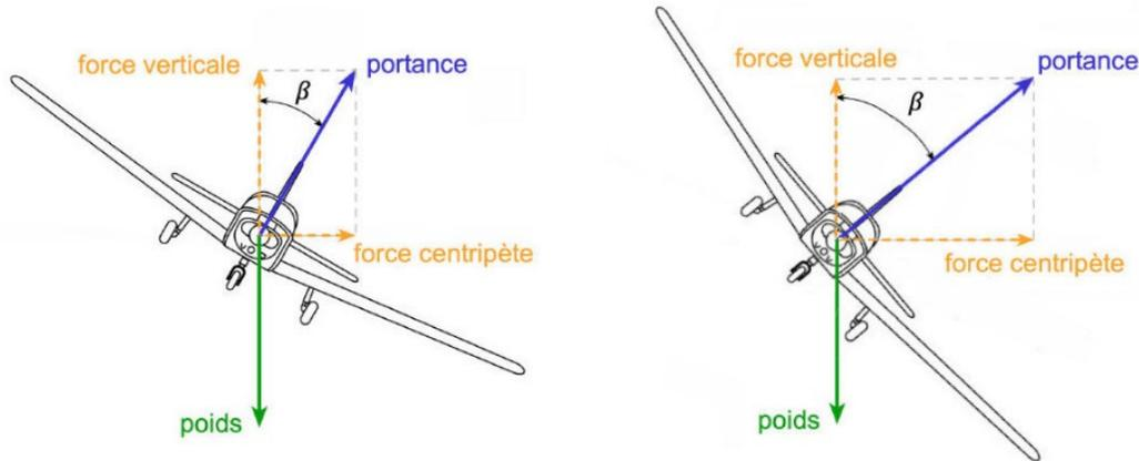
La composante verticale doit toujours être égale au poids de l'avion si on veut que la somme des forces en  $y$  soit nulle. Plus l'angle augmente, plus la portance doit être importante pour que la composante en  $y$  reste toujours égale au poids de l'avion.
