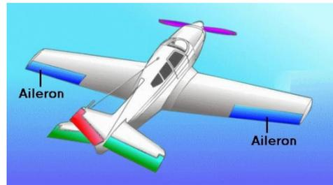
C'est pourquoi les commandes pour tourner contrôlent les ailerons sur les ailes.
