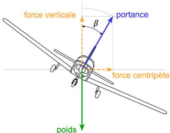
Il n'y a qu'une seule force qui peut être utilisée comme force centripète, c'est la portance. Si on incline l'avion, la portance va aussi s'incliner.
