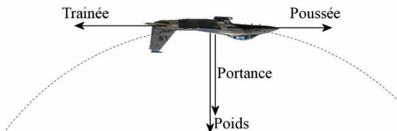
Puisque le centre du cercle est vers le bas, l'accélération centripète est vers le bas. Si la grandeur de la vitesse de l'avion varie, il peut y avoir une accélération tangentielle. On a donc les équations des forces suivantes (on utilise un axe des y vers le bas).
