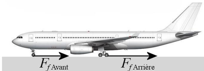
**Pour un avion, la force de friction faite par le sol ne peut agir que si l'avion est en contact avec le sol. Elle ne peut pas agir quand l'avion est en vol.**
