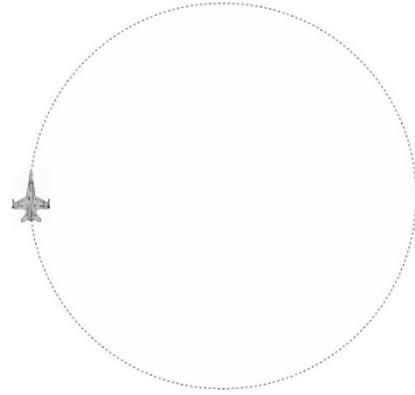
15. L'avion de la figure de droite se déplace avec une vitesse de  $360 \text{ m/s}$  en suivant une trajectoire circulaire. Quelle est la grandeur de son accélération centripète si l'avion fait un tour en  $180 \text{ s}$  ?
