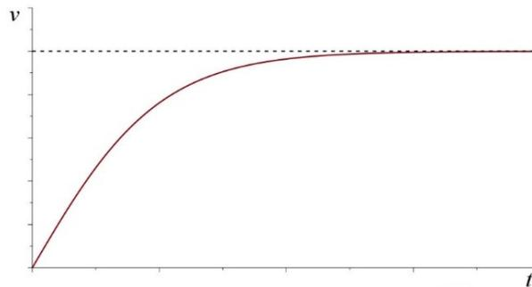
Le graphique montre que la vitesse des objets qui tombent dans l'air tend vers une vitesse limite (ligne pointillée horizontale). Comme cette vitesse limite dépend de la masse et la forme de l'objet, le mouvement des objets qui tombent dans l'air diffère selon la masse et la forme. On peut voir cet effet dans ce clip dans lequel on laisse tomber une cuisinière (l'appareil électroménager, pas la madame) et un oreiller.
