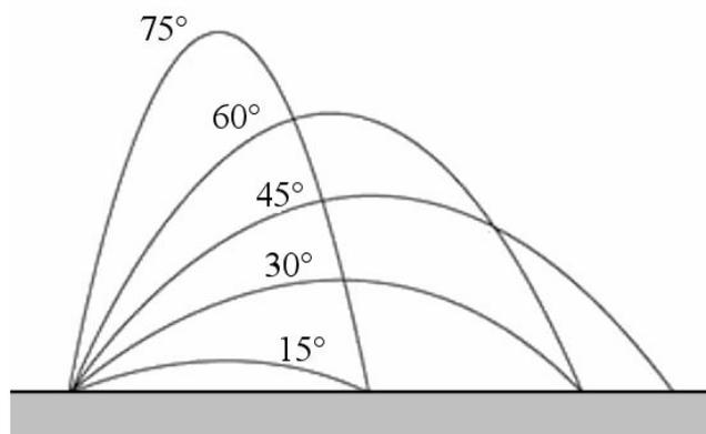
On remarque que la portée est la même pour des angles de  $30^\circ$  et de  $60^\circ$  et qu'elle est aussi la même pour des angles de  $75^\circ$  et  $15^\circ$ . En fait, les portées sont toujours les mêmes pour les angles  $\theta$  et  $90^\circ - \theta$ . On a la même portée parce que le  $\sin 2\theta$  a la même valeur pour ces deux angles.
