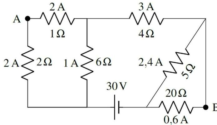
c) Le courant fourni par la source est le même que celui qui passait par la résistance équivalente, soit 3 A.
