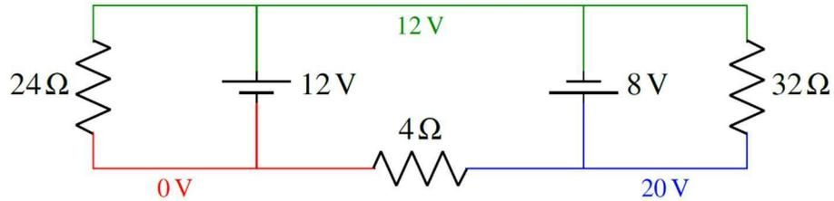
On remarque qu'il y a une différence de potentiel de 12 V aux bornes de la résistance de 24 Ω. Le courant est donc
