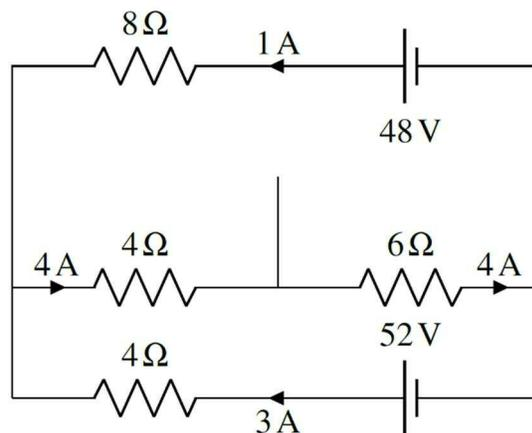
On va maintenant ramener les résistances en parallèle. Ces résistances ont la même différence de potentiel que les résistances équivalentes. Ainsi, aux bornes des résistances de  $12\ \Omega$  et de  $6\ \Omega$ , la différence de potentiel sera de
