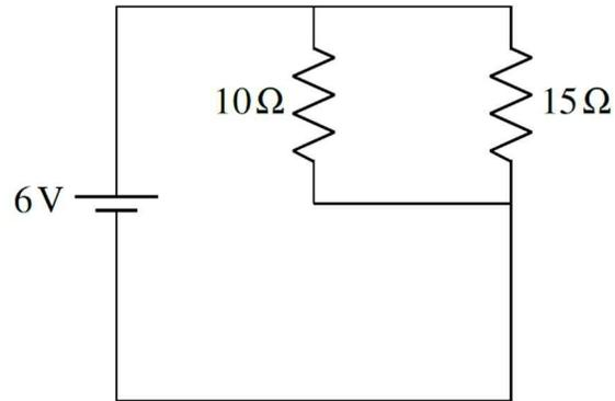
Il ne reste alors que les résistances de  $10\ \Omega$  et  $15\ \Omega$  sont en parallèle. La résistance équivalente est
