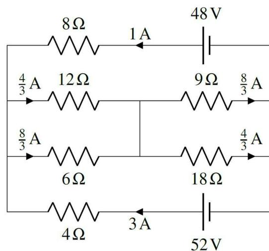
Il ne reste qu'à trouver le courant dans les trois petites branches verticales au milieu du circuit. Pour les trouver, on peut faire des lois des nœuds sur les nœuds en bas de ces branches (nœuds a, b et c sur la figure).
