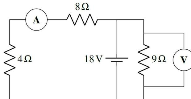
On voit assez facilement que la résistance équivalente est de  $12\ \Omega$  pour la partie gauche du circuit. Cette résistance équivalente est branchée aux bornes de la pile de  $18\ \text{V}$ . Le courant est donc
