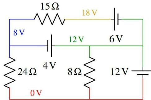
On remarque qu'il y a une différence de potentiel de 12 V aux bornes de la résistance de 8 Ω. Le courant est donc
