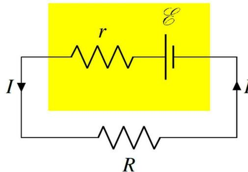
Si la puissance dissipée est de 1250 W et que la résistance est de 2  $\Omega$ , on peut trouver le courant dans la résistance.
