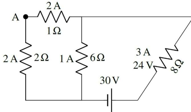
On va alors ramener les résistances en série de droite. En série, les résistances ont le même courant que la résistance équivalente. Le courant dans ces résistances est donc aussi de 3 A. Les différences de potentiel sont donc
