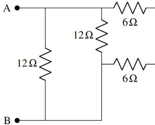
En haut à droite, nous avons alors une résistance de  $6\ \Omega$  en série avec une résistance de  $6\ \Omega$ . La résistance équivalente est
