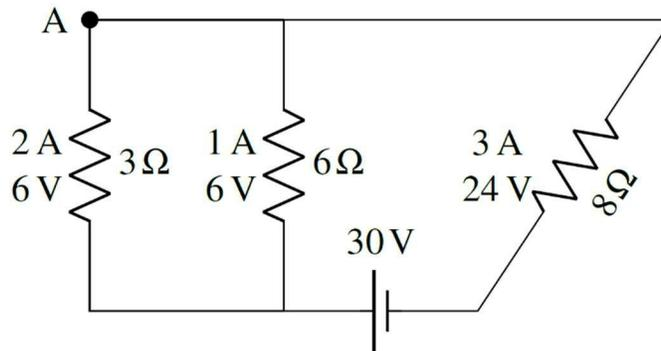
On va alors ramener les résistances en série de gauche. En série, les résistances ont le même courant que la résistance équivalente. Le courant dans ces résistances est donc aussi de 2 A.
