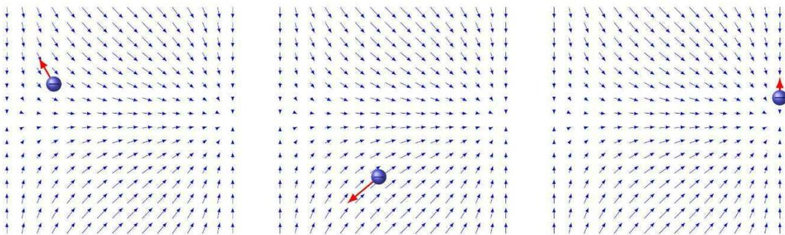
On voit que la force sur la charge négative est toujours dans la direction opposée au champ électrique. Cela est en accord avec la définition du champ puisqu'en multipliant le champ par une charge négative, on inverse la direction du vecteur. Encore une fois, la force est plus grande si le champ est plus grand.
