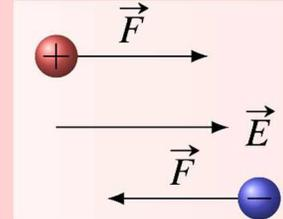
La force sur une charge positive dans un champ électrique est dans le même sens que le champ et la force sur une charge négative dans un champ électrique est dans la direction opposée au champ. Le vecteur  $F$  part toujours de la charge qui subit la force.
