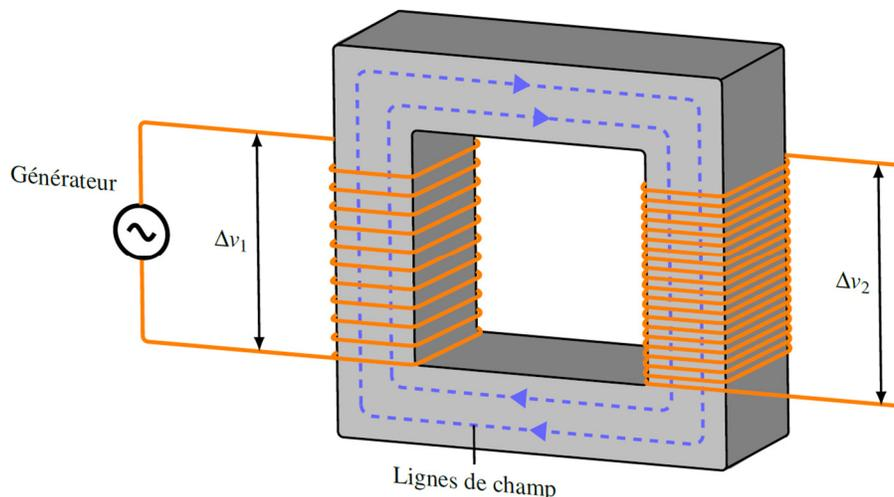
Si le courant varie dans la bobine 1, le champ sera variable et le flux dans la bobine 2 sera variable. La différence de potentiel induite dans la bobine 2 sera donc
