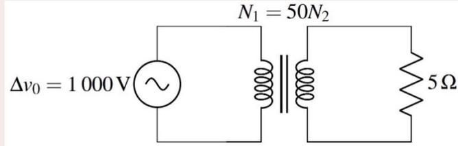
On branche ensuite une résistance de 5 Ω à la bobine secondaire. Dans le transformateur, la bobine primaire a 50 fois plus de tours de fils que la bobine secondaire.
