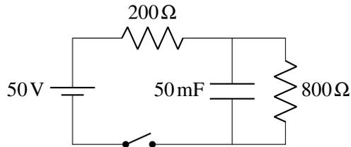
la différence de potentiel aux bornes du condensateur est aussi de  $40\ \text{V}$  puisque le condensateur est en parallèle avec la résistance de  $800\ \Omega$ . La charge du condensateur est donc de
