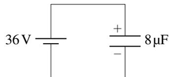
Sur la figure, on a spécifié les signes des armatures. C'est facile de déterminer ces signes puisque l'armature positive est toujours reliée à la borne positive quand on branche un condensateur à une source.
