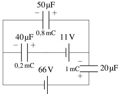
**Exercice 16 :** En suivant la maille montrée sur cette figure dans le sens des aiguilles d’une montre en partant du nœud le plus haut à droite
