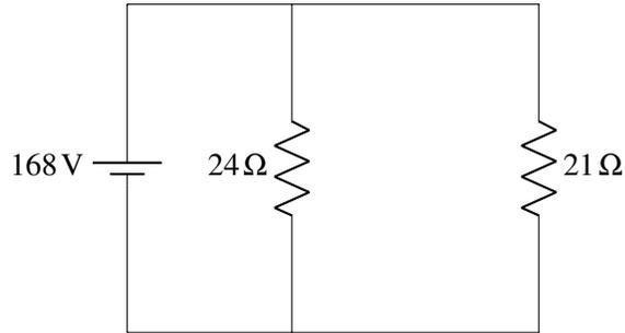
La différence de potentiel aux bornes de chacune de ces résistances est de 168 V puisqu'elles sont en parallèle avec la source. Le courant dans chacune est
