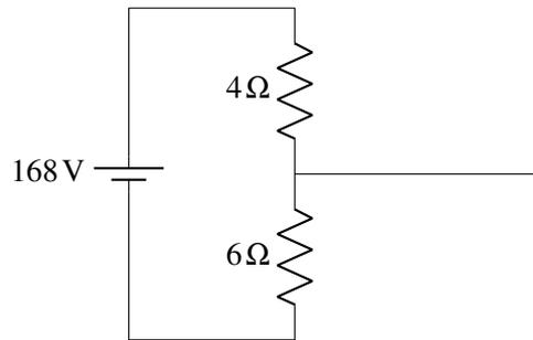
La résistance équivalente de ce circuit étant de  $10\ \Omega$ , le courant fourni par la source est
