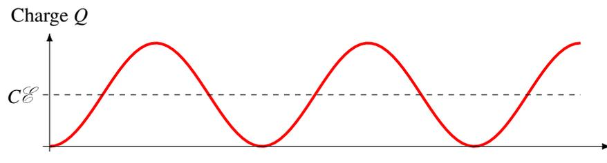
Puisqu'il s'agit d'une oscillation ayant une amplitude égale à  $C\mathcal{E}$  centrée autour de  $C\mathcal{E}$ , la valeur maximale doit être de  $2C\mathcal{E}$ . La charge maximale est donc de
