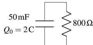
Il s'agit maintenant d'un circuit dans lequel un condensateur se décharge à travers une résistance. La charge initiale de cette phase de décharge est la charge finale de la phase de charge, soit  $2\ \text{C}$ . On peut maintenant calculer la charge 20 secondes après le début de la décharge. Cette charge est
