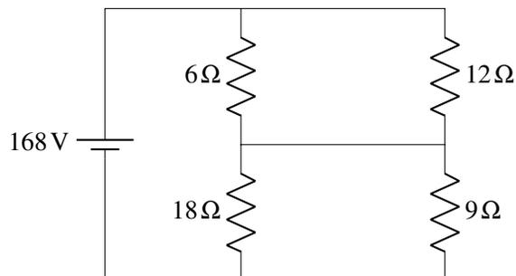
Nous avons alors une résistance de  $6\ \Omega$  en parallèle avec une résistance de  $12\ \Omega$  et une résistance de  $9\ \Omega$  et parallèle avec une résistance de  $18\ \Omega$ . Les résistances équivalentes sont
