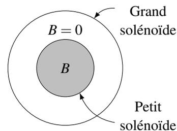
On doit donc séparer l'aire en deux parties. Une des parties est l'aire à l'intérieur du solénoïde ayant un rayon de 2 cm et l'autre partie est l'aire entre les deux solénoïdes. Comme il n'y a pas de flux dans la deuxième partie, on ne calcule que le flux dans le solénoïde ayant un rayon de 2 cm. On a donc
