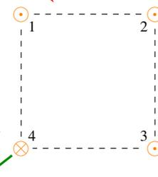
**Exercice 10 :** Les deux bouts de fils sur la figure avec un X rouge ne contribuent pas au champ puisque le point P est aligné avec le fil.
