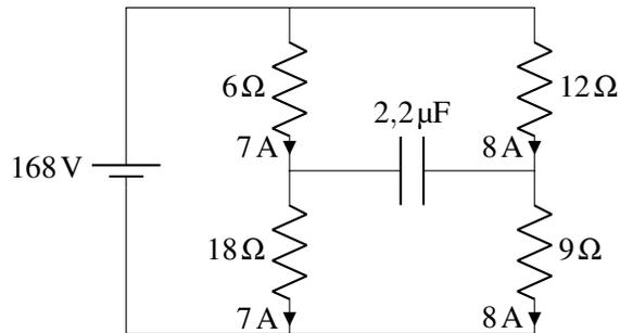
On peut trouver la charge du condensateur avec une loi des mailles de Kirchhoff dans la maille en haut à droite. On va partir du coin supérieur droit et aller dans le sens contraire des aiguilles d'une montre. On a donc
