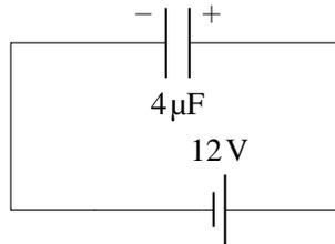
Sur la figure, on a spécifié les signes des armatures. C'est facile de déterminer ces signes puisque l'armature positive est toujours reliée à la borne positive quand on branche un condensateur à une source.
