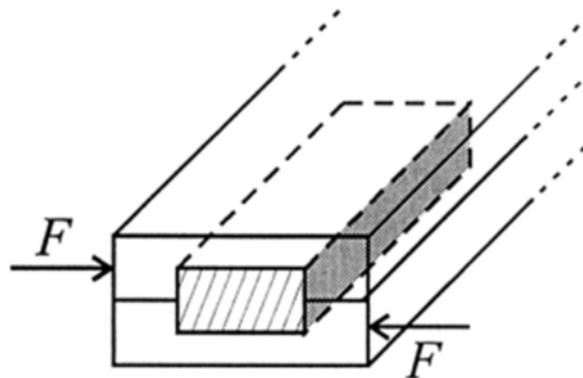
16. Une tige supportant une force de tension  $F$  est reliée à deux barres par un boulon en cuivre de 1 cm de diamètre. Quelle est la force  $F$  maximale que l'on peut appliquer sur la tige avant que le boulon ne casse ?
