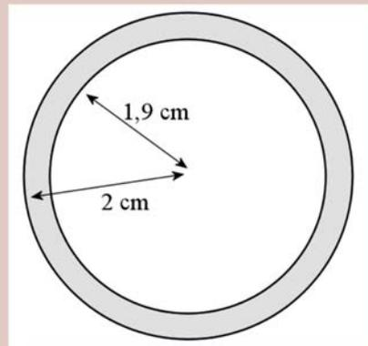
L'aire de cette section est l'aire d'un cercle de 2 m de rayon à laquelle on soustrait l'aire d'un cercle de 1,9 cm de rayon
