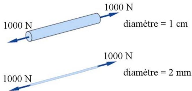
Pour la tige d'acier, la section est un petit cercle de 0,5 cm de rayon (Rappel : le rayon est la moitié du diamètre d'un cercle). L'aire de la section est alors
