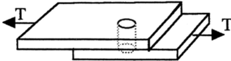
**15.** Une clavette (en aluminium 6061-T6) retient deux pièces soumises à une force de cisaillement de  $F = 80\,000$  N. La clavette a une épaisseur de 16 mm, une largeur de 25 mm et une longueur de 150 mm.
