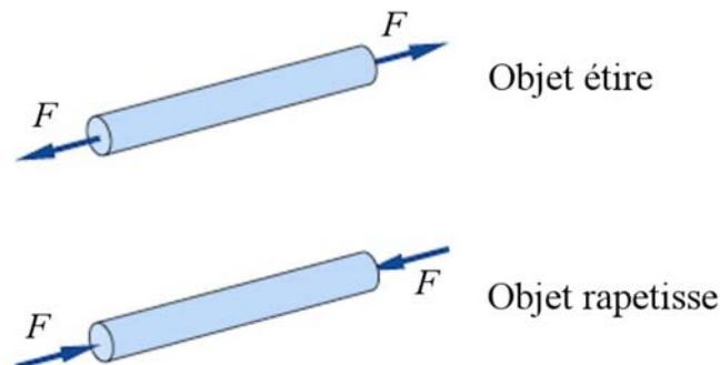
Il se peut que l'étirement ou la compression disparaissent quand on enlève la force de tension ou de compression. C'est ce qui arrive si la contrainte est inférieure à la limite d'élasticité. Si la contrainte est supérieure à la limite d'élasticité, la déformation faite par la contrainte sera permanente.
