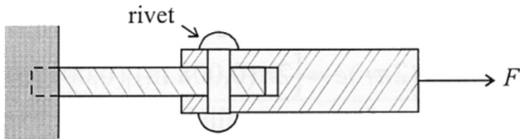
18. Sur la figure suivante, la force  $F$  exercée par la lame ne doit pas dépasser 10 533 livres. Quelle est l'épaisseur maximale d'une tôle d'aluminium 3003-H14 de 6 pouces de largeur que l'on peut découper à l'aide de cette lame ?
