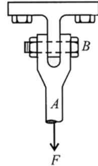
17. Une barre est encastrée dans une paroi. Cette barre est rivetée à une barre rainurée. Le rivet a un diamètre de 0,5 cm.
