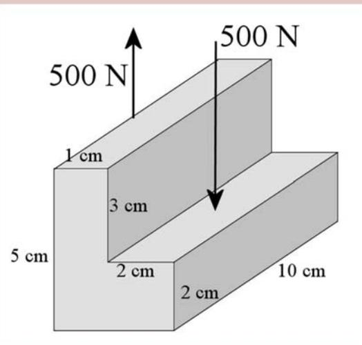
Il est assez clair qu'on doit prendre  $F = 500\text{ N}$  dans la formule de la contrainte. Pour trouver l'aire, on doit imaginer que le support casse sous l'effet de la contrainte. On aurait alors les deux morceaux suivants.
