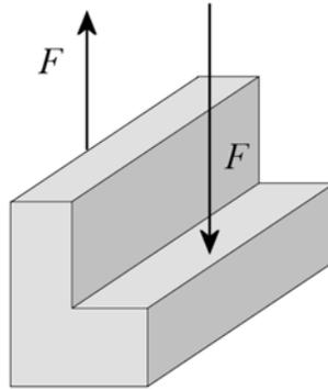
La flèche vers le bas correspond au poids fait par l'objet supporté et la flèche vers le haut correspond à la force qui retient le support sur le mur. Avec ces deux forces opposées qui ne sont pas alignées l'une avec l'autre, le support est soumis à un cisaillement.
