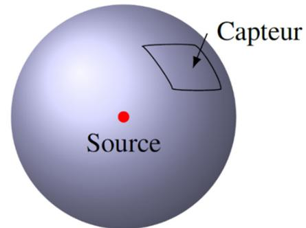
À cette distance  $D$ , il y a un capteur ayant une aire  $A_{\text{capteur}}$ . Le capteur ne capte qu'une partie de l'énergie émise par la source. La proportion captée est donnée simplement par le rapport entre l'aire du capteur ( $A_{\text{capteur}}$ ) et l'aire totale sur laquelle est répartie la puissance.
