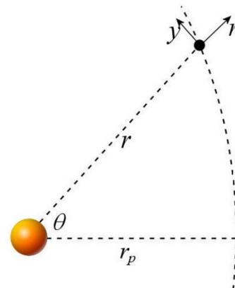
Une partie de la force va servir à faire l'accélération centripète pour garder le corps à la même distance de la masse centrale. S'il y a plus ou moins de force que la force centripète nécessaire, cet excès ou ce manque de force fera changer la distance  $r$ . On peut donc écrire l'accélération comme étant
