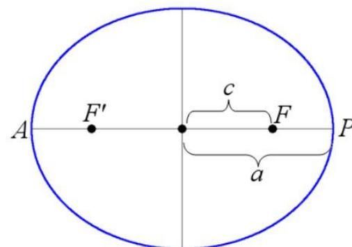
où  $c$  est la distance entre le centre de l'ellipse et un des foyers et  $a$  la distance entre le centre de l'ellipse et une des apsides (il s'agit du demi-grand axe).
