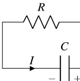
Le courant va de l'armature positive à l'armature négative du condensateur.
