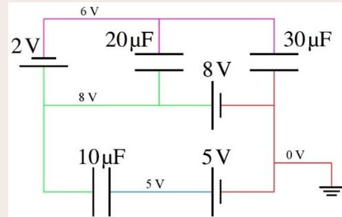
On voit qu'il y a 2 V de différence de potentiel aux bornes du condensateur de  $20\ \mu\text{F}$ . Sa charge est donc
