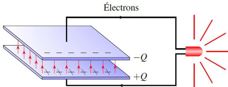
L'ampoule va fonctionner jusqu'à ce qu'il n'y ait plus d'énergie dans le condensateur.
