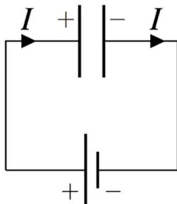
La source doit donc fournir des charges pour charger les armatures du condensateur. Il y aura donc un courant dans le sens montré sur la figure de gauche. Ce courant amène des charges positives à une armature, ce qui la rend positive, et enlève des charges positives à l'autre armature, ce qui la rend négative (on va supposer ici que ce sont les charges positives qui se déplacent pour que les charges se déplacent dans le sens du courant).
