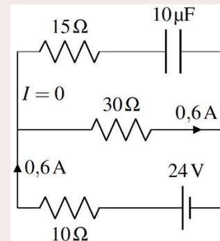
Comme il n'y a pas de courant dans la résistance de  $15 \Omega$ , on doit aussi avoir une différence de potentiel de  $18 \text{ V}$  aux bornes du condensateur. La charge du condensateur est donc
