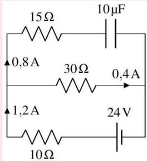
La différence de potentiel aux bornes de chaque résistance de  $10\ \Omega$  est donc de  $12\ V$ . Cela signifie que la différence de potentiel aux bornes des résistances de  $30\ \Omega$  et  $15\ \Omega$  est aussi de  $12\ V$  (les résistances en parallèle ont la même tension que leur résistance équivalente). Les courants circulant dans ces résistances sont donc
