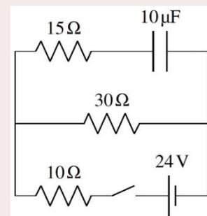
On a alors deux résistances en série avec une résistance équivalente de  $20\ \Omega$ . Le courant dans le circuit est donc
