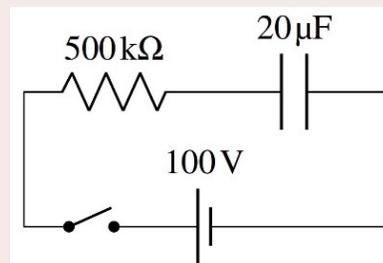
La constante de temps de ce circuit est  $RC = 500 \text{ k}\Omega \cdot 20 \mu\text{F} = 10 \text{ s}$ . (C'est une bonne idée de la calculer en partant parce qu'elle revient dans toutes les équations.)
