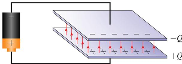
Une fois que les armatures sont chargées, on peut débrancher la source et les armatures restent chargées puisque les charges ne peuvent pas traverser le vide ou l'isolant entre les armatures. L'énergie du condensateur va donc demeurer la même.
