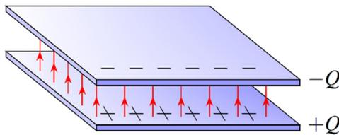
Plus tard, on pourrait brancher une ampoule aux armatures du condensateur. Les électrons en surplus dans l'armature négative pourront alors se déplacer vers l'armature positive. Ce courant va allumer l'ampoule.
