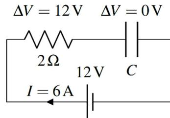
Ainsi, à  $t = 0$ , le courant est exactement le même que ce qu'on aurait s'il n'y avait pas de condensateur puisque ce dernier ne fait aucune différence de potentiel. Ce sera toujours le cas à  $t = 0$  avec des circuits où les condensateurs sont initialement vides.
