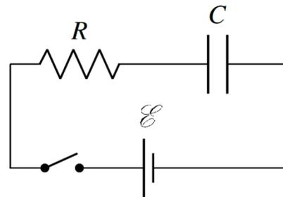
**Charge en fonction du temps pour un circuit RC (on charge le condensateur avec une source)**
