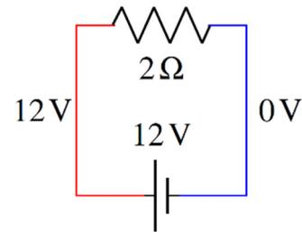
Donc, même s'il ne semble y avoir que des résistances dans un circuit, ce circuit est en réalité un circuit RC. Bien souvent, la capacité est assez faible pour qu'on puisse la négliger.
