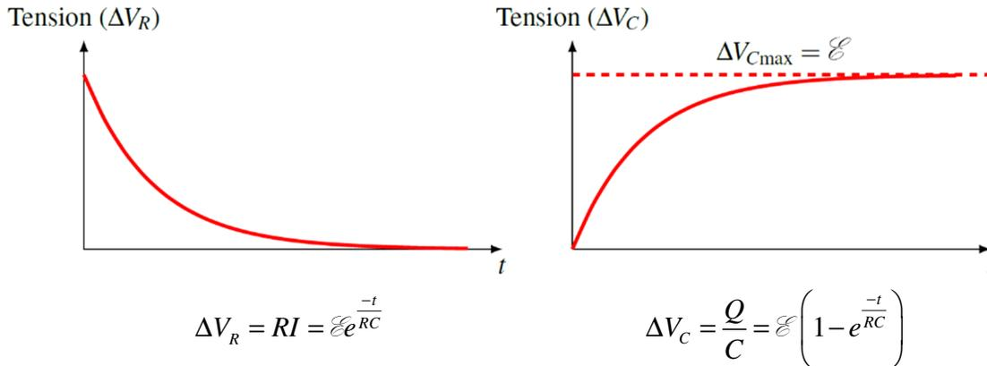
Puisque la différence de potentiel aux bornes de la résistance est  $RI$ , cela veut dire que le courant doit diminuer si la différence de potentiel aux bornes de la résistance diminue. Dans notre exemple, le courant n'est plus que de 2 A quand la différence de potentiel aux bornes de la résistance de  $2 \Omega$  est de 4 V.
