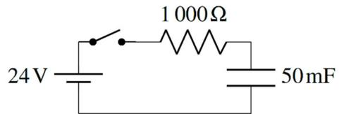
11. Dans le circuit suivant, le courant diminue à  $50\%$  de sa valeur initiale en  $5 \text{ ms}$  après la fermeture de l'interrupteur. Quelle est la capacité du condensateur ?
