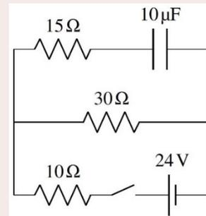
Au bout d'un temps très long, il n'y a pas de courant dans la branche du haut. On peut donc l'éliminer pour trouver les courants ailleurs dans le circuit. (Si, après cette étape, il ne reste plus aucune maille, cela veut dire que tous les courants sont nuls.) On a alors le circuit de gauche.
