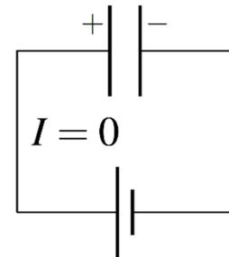
En résumé, la source va charger le condensateur jusqu'à ce que la différence de potentiel aux bornes du condensateur soit identique à celle de la source. Une fois le condensateur chargé, il n'y a plus de courant.
