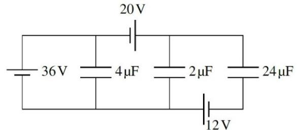
5. Quelle est la charge de chacun des condensateurs de ce circuit ? (Spécifiez aussi les signes des armatures.)
