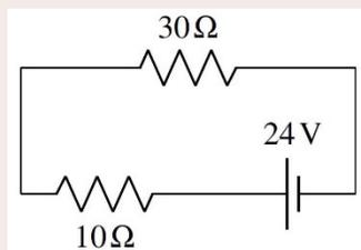
On a alors deux résistances en série avec une résistance équivalente de  $40\ \Omega$ . Le courant dans le circuit est donc
